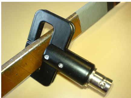
Obr. 3. Induktivní senzor pro měření částečných výbojů. Fig. 3. Inductive sensor for PD detection.
