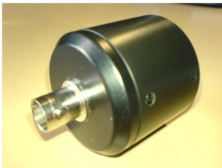
Obr. 2. Kapacitní senzor výrobce Lemke Diagnostics. Fig. 2. Capacitive sensor made by Lemke Diagnostics.
